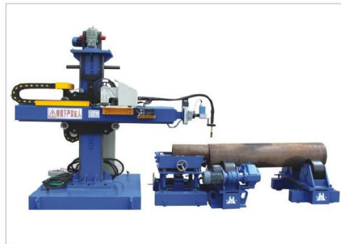
➤ 电极对焊中心 / Electrode welding center
