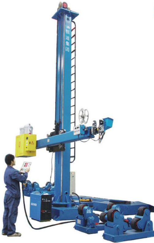
○ 操作机使用中 / Testing of manipulator
